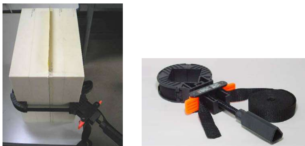
図 7.7 専用の器具を持たない固体ファントムでアキシアルやサジタル面を測定する場合，布製クランプ（図右）などでファントムとフィルムを十分に圧着する必要がある。
