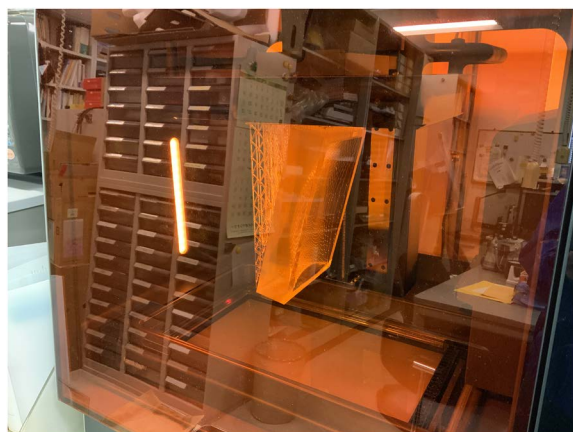
図4 3Dプリンターを用いた可変形乳房ファントムの作製。3Dプリンターで乳房の型を出力し、そこに素材を流し込むことでよりリアルな可変形ファントムを作製する
