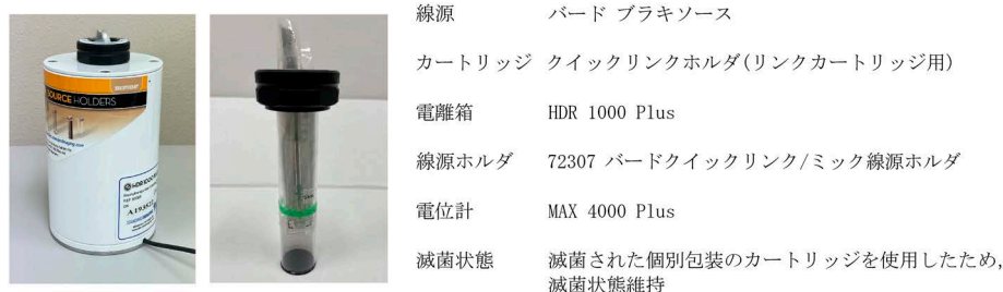
図5 ウェル形電離箱HDR 1000 Plusの外観と使用機器 左：ウェル形電離箱，右：線源ホルダ72307とクイックリンクカートリッジ
