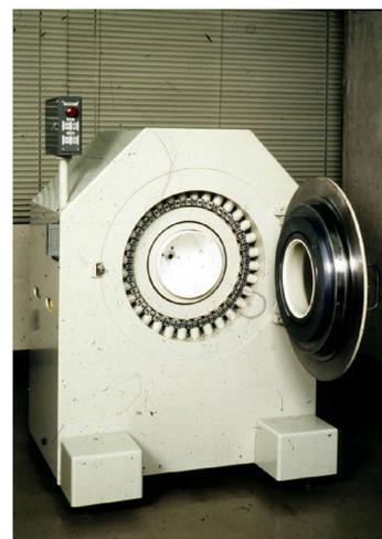
図3 日本最初のPET装置<sup>1)</sup>
