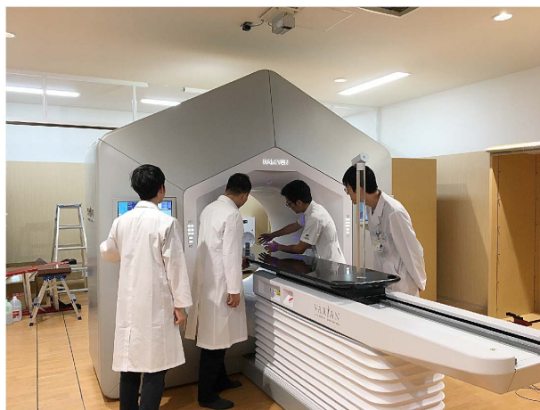
図1 2020年度稼働予定のHalcyonのアクセプタンスの様子
