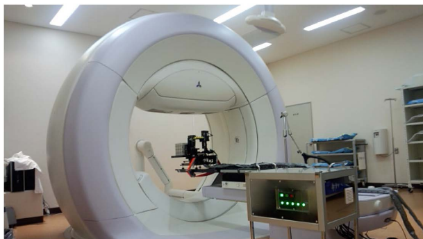
図2 Vero4DRTの動体追尾精度検証
