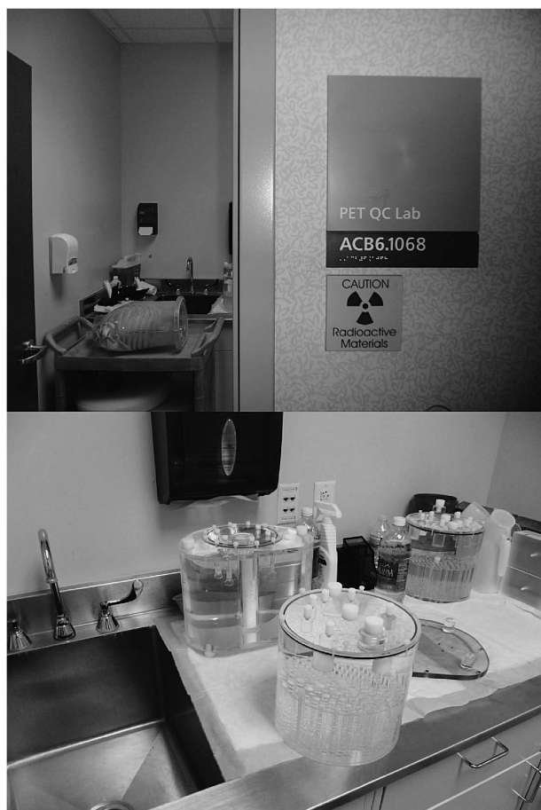
Fig. 8 PET QC Lab. PET画像の画質評価は主にACR phantomを用いて実施していた。
