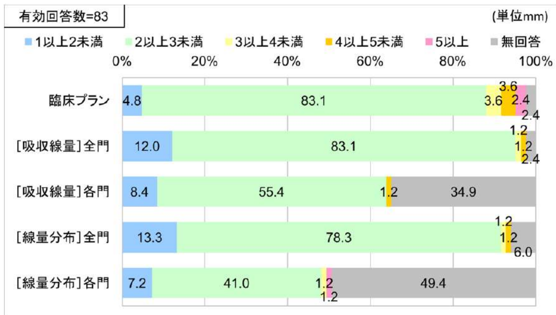
図 2-2-1-2 頭頸部 IMRT の臨床プランおよび QA プランで採用している線量計算グリッドサイズ。
